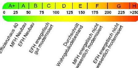
Die modellhaft ermittelten Vergleichswerte beziehen sich auf Gebäude, in denen Wärme für Heizung und Warmwasser durch Heizkessel im Gebäude bereitgestellt wird.
