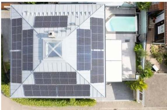
Auf dem Dach befindet sich eine 22kW PV-Anlage mit großem Speicher.
